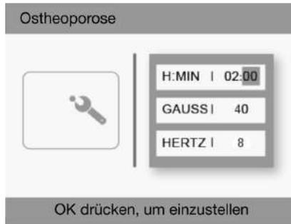
c) Durch die Tasten  und  die gewünschten Therapieminuten (von 0 bis 59) einstellen und durch Drücken der OK-Taste bestätigen. Auf dem Display wird die Behandlungsstärke angezeigt;
